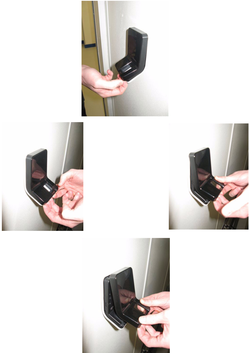
Figure 3.26: Déboîtage de la face avant fumée
